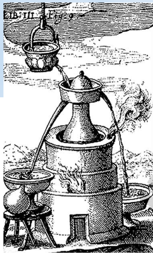
«Голова мавра» с водяным охлаждением вокруг шлема перегонного куба.
